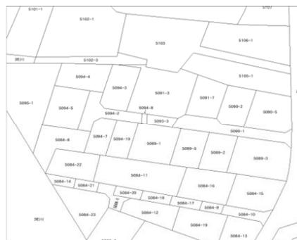
地籍調査により、境界の位置を正確に測量した地図が作成されます。
