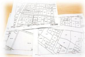
地積測量図等の境界に関する既存資料がある場所は、既存資料と現況境界測量図の整合性を確認します。その結果、調整した境界点の位置を現地に明示します。
