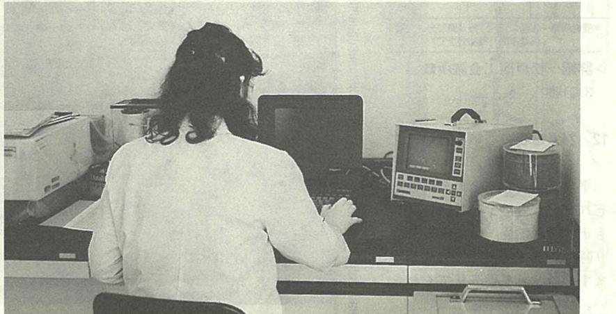
放射能の測定中です。写真右は放射能測定機一式
