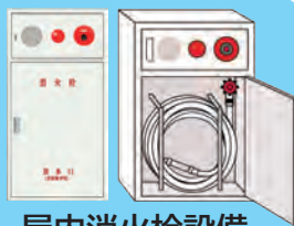
屋内消火栓設備
