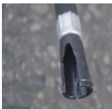
× ノズルの破損
