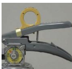
× レバー支えの脱落
