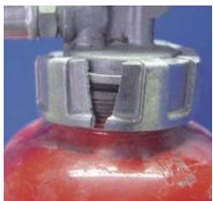
× キャップの破損
