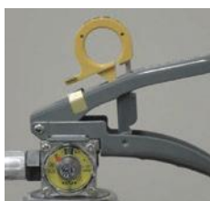
× 安全栓の抜けかけ
