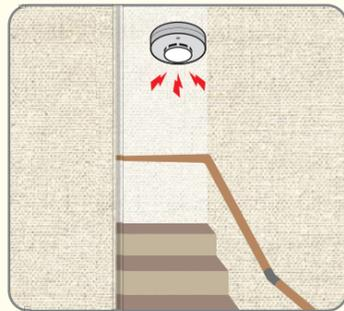
2階に寝室がある場合、階段の天井面等に煙式の警報器を設置
