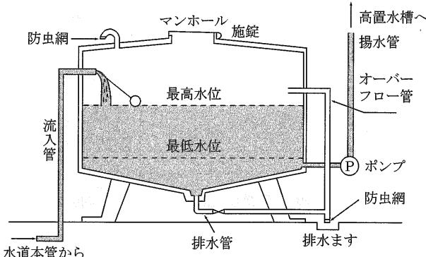
簡易専用水道は、県や市町村等の水道（水道事業）から供給される水のみを水源として、一旦受水槽に貯留し、高置水槽や圧力タンク等で給水する水道で、受水槽の有効容量が10m<sup>3</sup>を超えるものが該当します。
