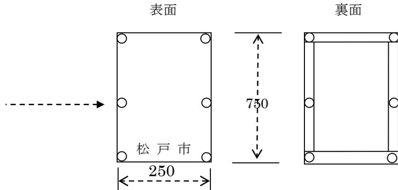
4. 材質 反射ターポリン (黄色、再帰反射性の材質、厚み 0.40mm 以上)
