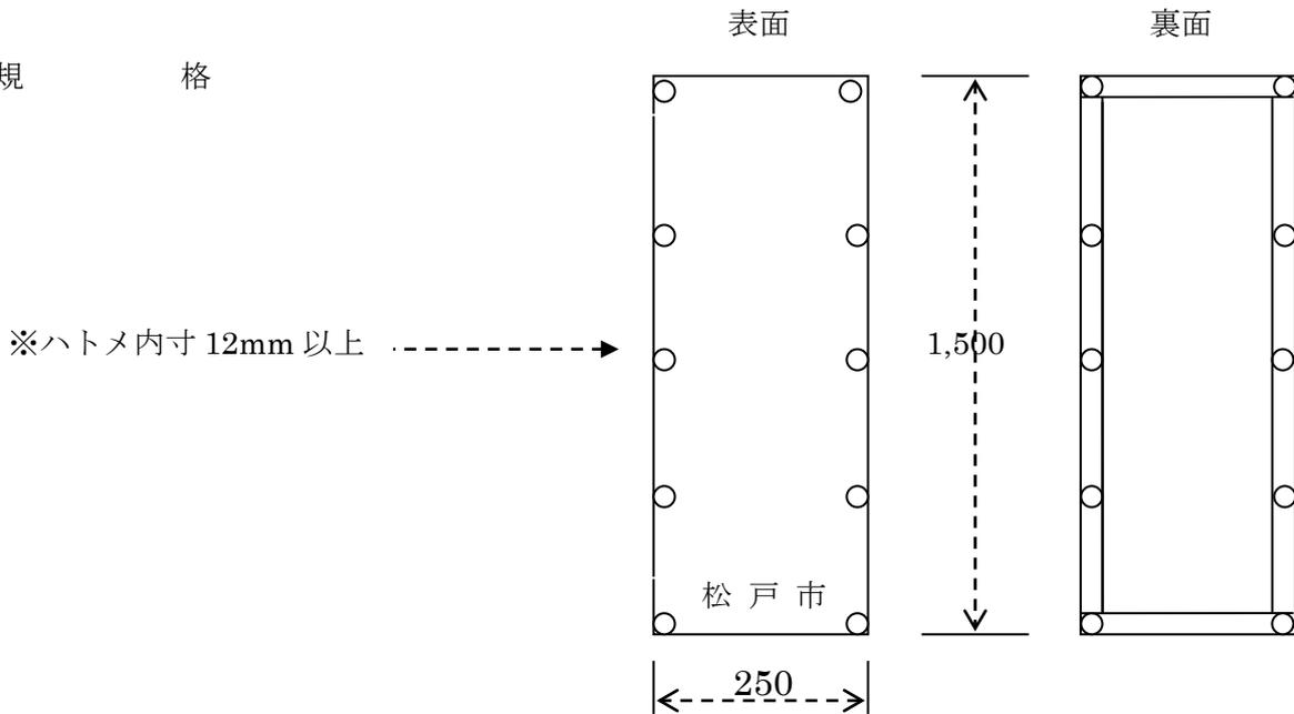
4. 材質 反射ターポリン (黄色、再帰反射性の材質、厚み 0.40mm 以上)
