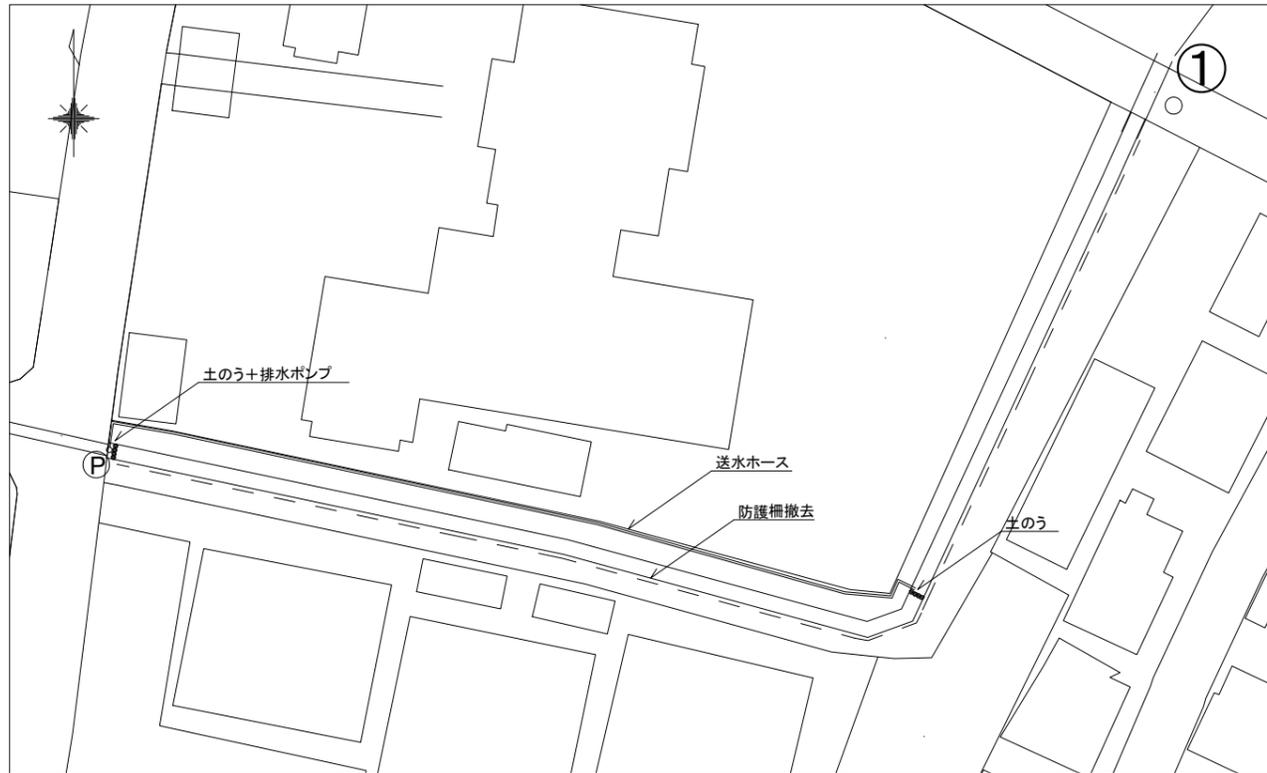
3.組立柵渠水路設置工(底板Co含む) + 搬入路撤去工(掘削・敷鉄板撤去)
