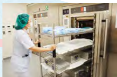
密封した状態で135度の蒸気で滅菌 高温に弱い器具はガスやプラズマで
